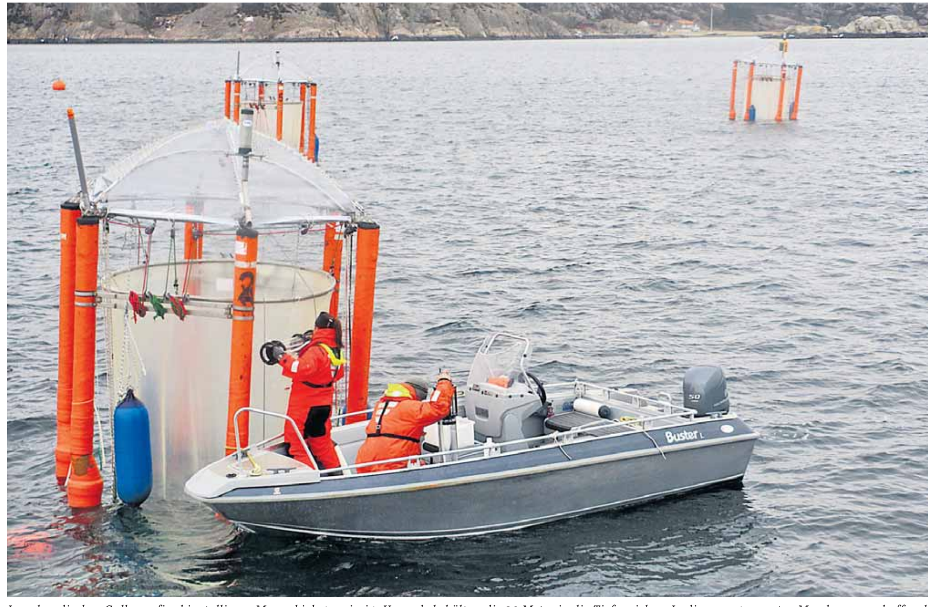
Im schwedischen Gullmarsfjord installieren Meeresbiologen riesige Versuchsbehälter, die 20 Meter in die Tiefe reichen. In diesen sogenannten Mesokosmen schaffen die Forscher auf künstliche Weise Bedingungen, wie sie in einigen Jahrzehnten überall im Meer herrschen könnten.
