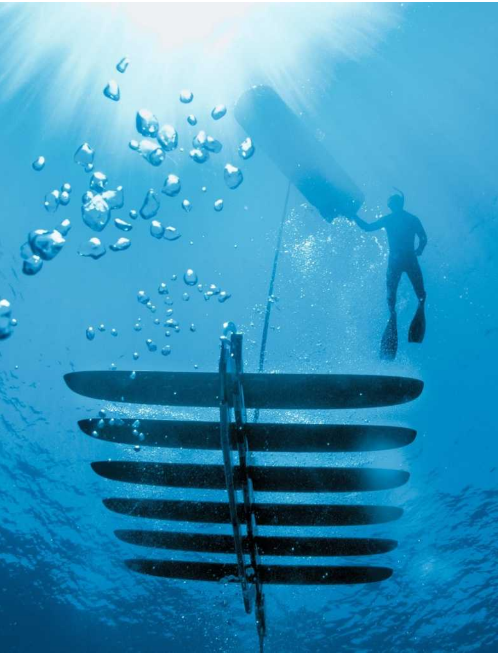
Der Wave Glider besteht aus einem Schwimmkörper und einem Flügelskelett, das Wellen in Vortrieb verwandelt
